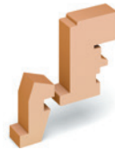
Tapée intérieure rapportée pour isolation de 60 mm
